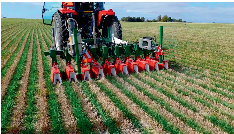
Forsøgssprøjte med forbedret afskærmning. Efter monteringen af disse afskærninger opnås en langt bedre præcision i rækkebehandlingerne, og afdrift til afgrøden minimeres. Foto: Kristian Juranich.
