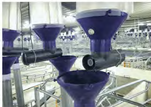
Billede 2: Eksempel på placering af den lille snegl under eksisterende foderkasser (Foto: Agrisys).
