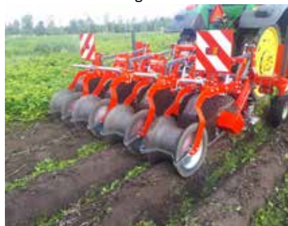
I 2021 blev der afprøvet et nyt redskab til mekanisk vækststandsning Vegniek DiscMaster, som forudsætter en forudgående aftopning, hvorefter roterende tallerkner (discs) trækker stængelstykkerne op af jorden. Foto: Lars Bødker, Seges.
