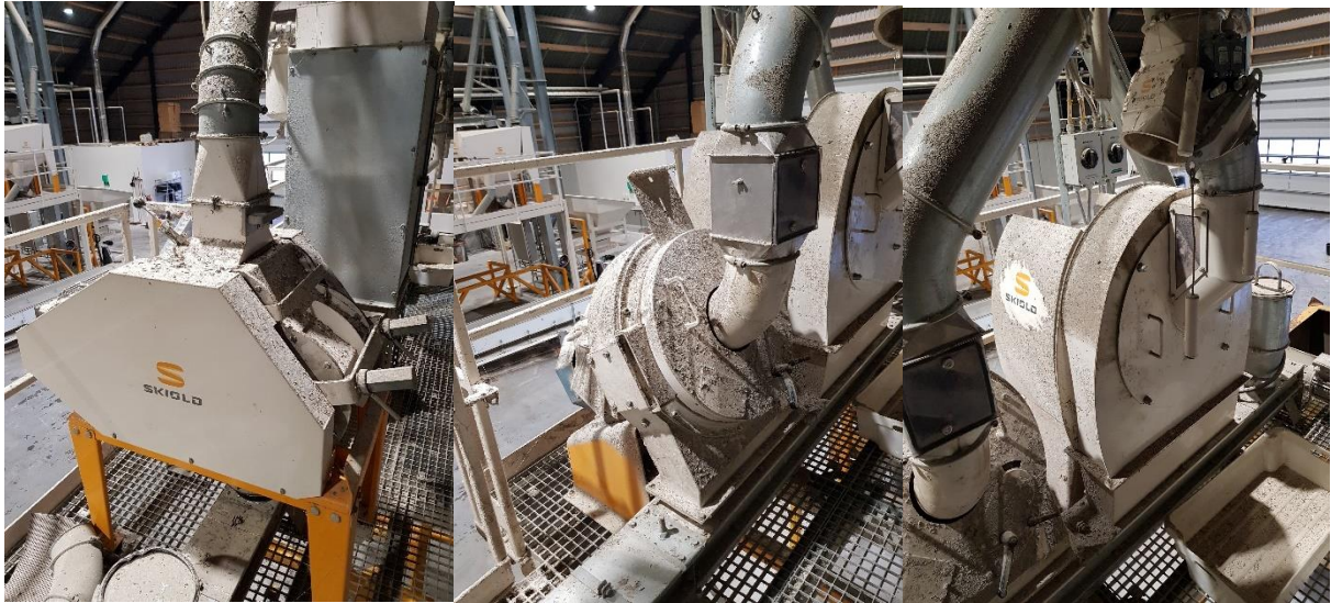
Billede 2. Illustration af møller i test: Hammermølle længst til højre, Skivemølle i midten og Valsemølle længst til venstre
