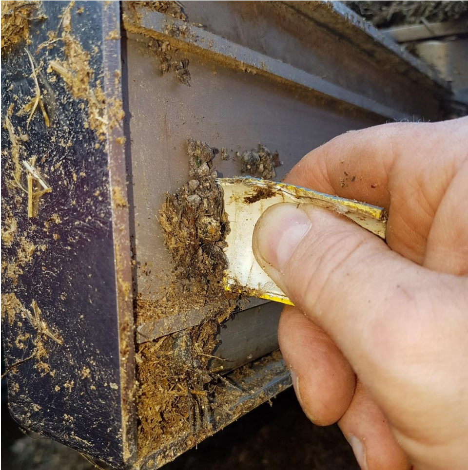
Foto 4. Hyppig rensning af magneter i fuldfoderblandere er afgørende for effekten af magneterne. Brug et stykke hård plast eller som her en stump flækket vandslange så du ikke kommer til skade på metalstykkerne.
