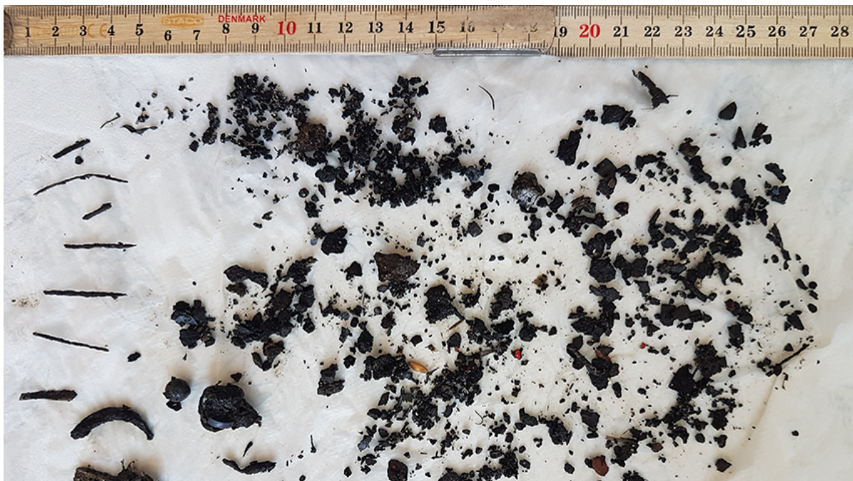
Metal tilbageholdt i en JF-Stoll VM-45 fuldfoderblander monteret med to topmagneter fra Grønning Smede- og Maskinforretning. Foto: SEGES
