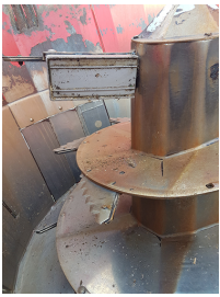
Topmagnet udviklet af Grønning Smede- og Maskinforretning til Kongskilde/F-Stoll-fuldfoderblandere. Foto: SEGES
