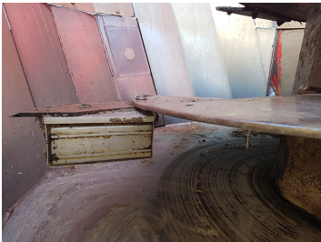
Knivplademagnet udviklet af Grønning Smede- og Maskinforretning til Kongskilde/F-Stoll-fuldfoderblandere. Foto: SEGES
