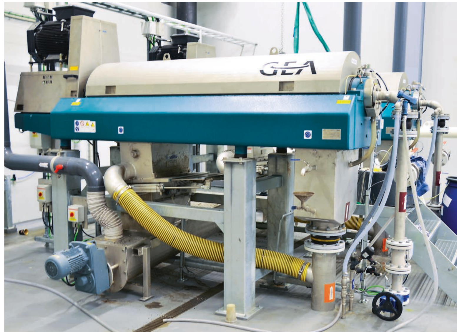
De fleste biogasanlæg, som separerer gylle, anvender en dekantercentrifuge til opgaven.
