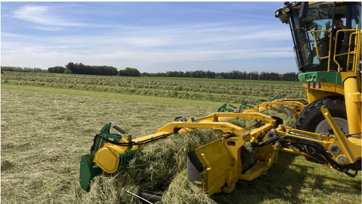
Billede 2. Plöeger har en øvre valse der sammen med pickuppen komprimerer græsset før levering på båndet. Resultatet er et smal og kompakt skår. Foto: Henning Sjørsløv Lyngvig.
