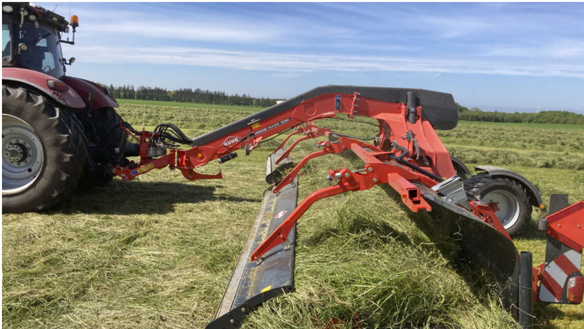
Billede 3. Kuhns pickuprive kaster græsset ind på båndet. Resultatet er et smalt men luftigt skår. Foto: Henning Sjørsløv Lyngvig.
