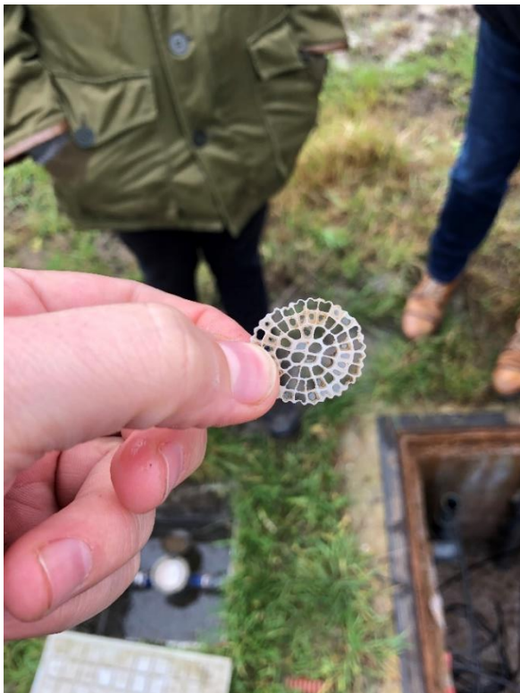
Billede 1. Nærbillede af en Anoxkaldnes K5 carrier, hvorpå der gror biofilm. Foto: Sebastian Zacho, SEGES
