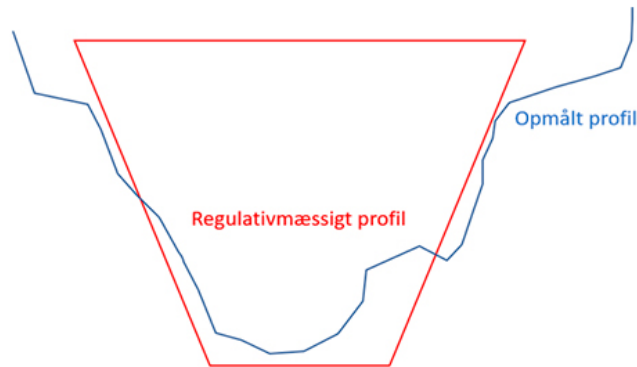
Figur 3. Skitsering af et opmålt profil og dets regulativfastsatte mål i et vandløb med teoretisk skikkelse. Kilde: Thøger Nisbeth Henriksen, SEGES.
