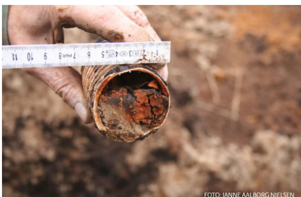
Figur 4.6: Drænrør kan være defekte fordi de er blevet stoppet til af okker (venstre) eller er blevet klemte (højre). Fotos: Janne Aalborg Nielsen.
