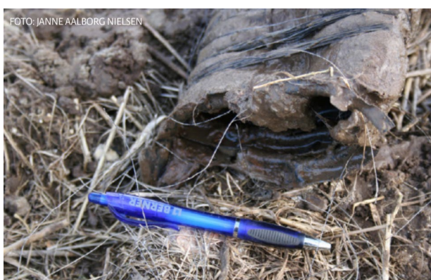
Figur 4.6: Drænrør kan være defekte fordi de er blevet stoppet til af okker (venstre) eller er blevet klemte (højre). Fotos: Janne Aalborg Nielsen.
