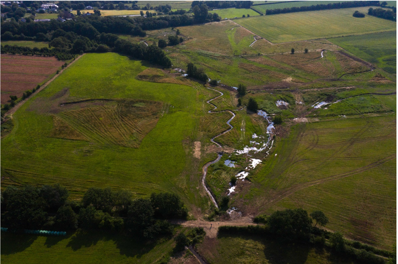
Figur 4 Vandløbsnært vådområde med sløjfede dræn, der overrisler det tilstødende engområde, samt en naturligt høj grundvandsstand langs vandløbet. (Foto: Thøger N. Henriksen, SEGES)
