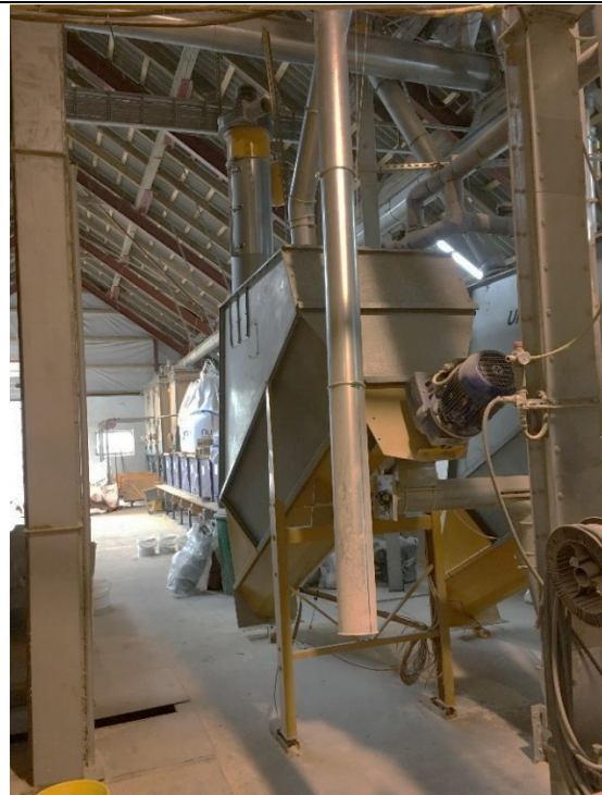
Foto 4: Nedfaldsrør fra klappkasse til prøveudtagning af formalet korn
